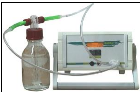
شکل شماره ۲- اندازه‌گیری غلظت رادن ۲۲۲ توسط دستگاه رادن سنج مدل RTM1688-2
