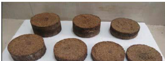
شکل ۳: اشکال پوسته بادام زمینی بعنوان جاذب‌های آکوستیکی
