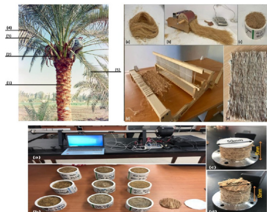
شکل ۴: استفاده از پوست درخت نخل بعنوان جاذب صوتی
