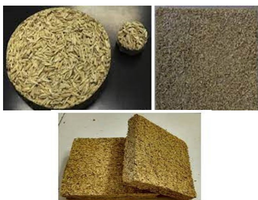
شکل ۱: نمایی از اشکال متفاوت مورد استفاده از پوسته برنج در جاذب‌های آکوستیکی
