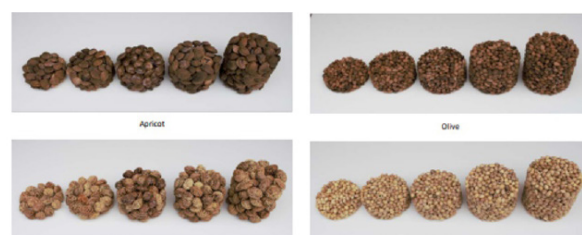
شکل ۵: استفاده از هسته میوه‌های زیتون، گیلاس، هلو و زردآلو به عنوان جاذب صوت
