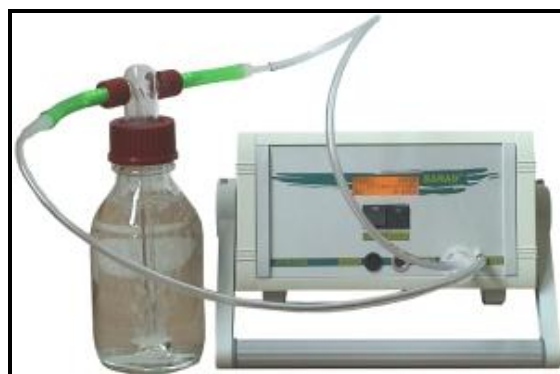
شکل شماره ۲- اندازه‌گیری غلظت ^{222}\text{Rn} توسط دستگاه رادن سنج مدل RTM1688-2
